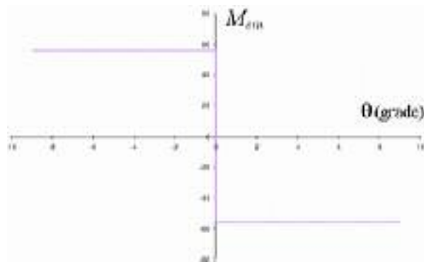
Figura 2: Dependența cuplului în funcție de poziție (în ipoteza permeabilității infinite a fierului)
